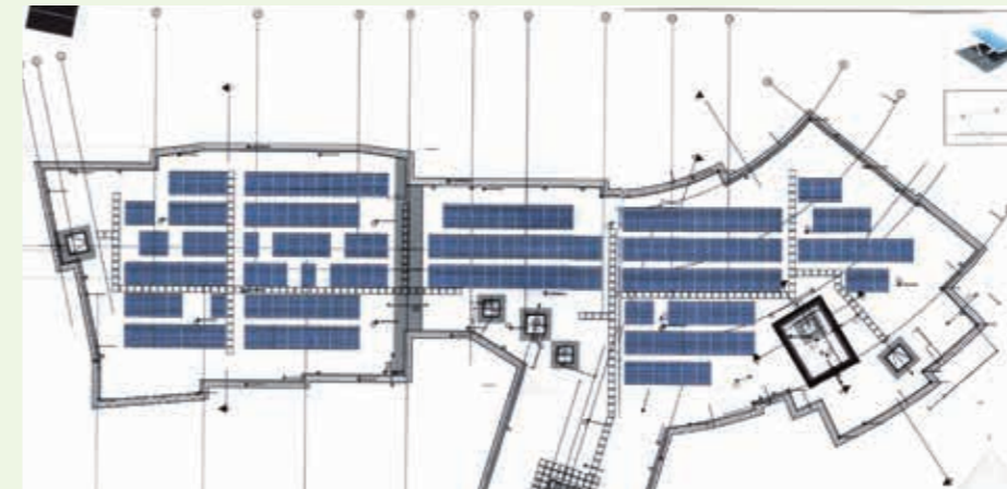
Planzeichnung der 96 KW Peak Photovoltaik Anlage, die noch dieses Jahr in Betrieb gehen soll.
